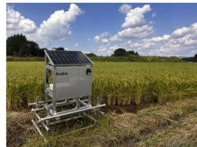
eco発電の計測BOXで水田のデータを観測しています
