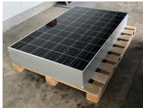
1次保管場所にて洗浄・拭き上げ作業 再度外観検査（能力検査も可）
