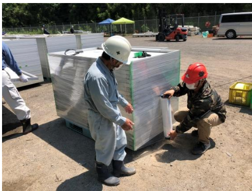
外観検査、選別作業 発生現場にてパレット積み PPバンドやラップにて固縛
