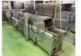
3段式電気式フライヤー5.7m：1台 消費電力：59.4kW
