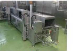
3段式電気式フライヤー5m：1台 消費電力：52.8kW
