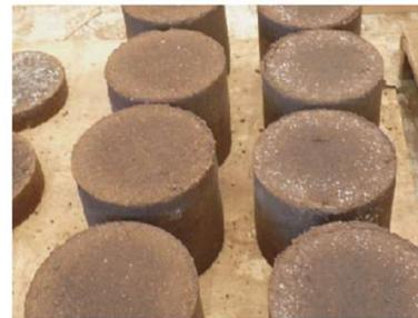
MOFU-DX には鉄鋼スラグもブレンドされており、MOFU-DX から溶出される鉄分も有用な栄養分として評価されています。
