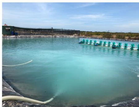
写真右： ファインバブル発生装置が稼働中の養殖池
