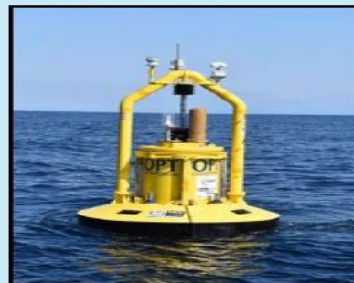
機械式波力発電 （提供：三井造船）
