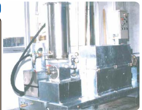
工業高校の実験室に設置したプラスチック油化理化学試験機
