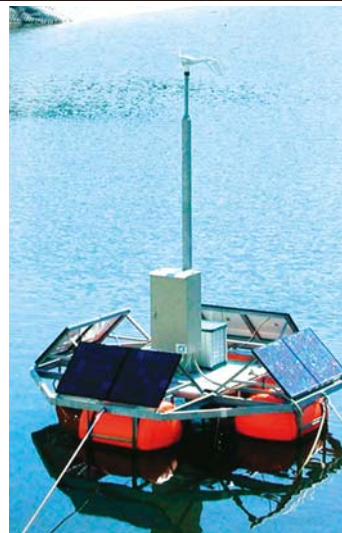
浮島型水質浄化装置
