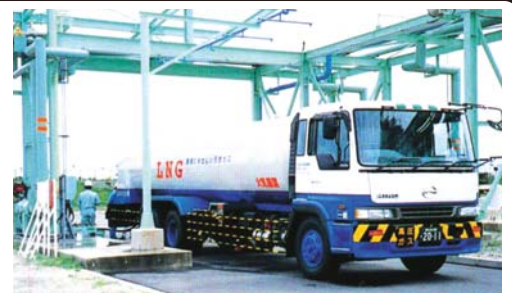
LNGローリー車
