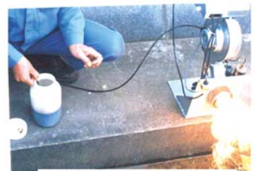
回収油の燃焼実験
