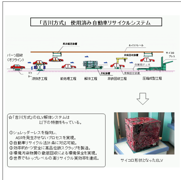
使用済み自動車 (ELV) の解体工程とサイコロ形状となったELV
