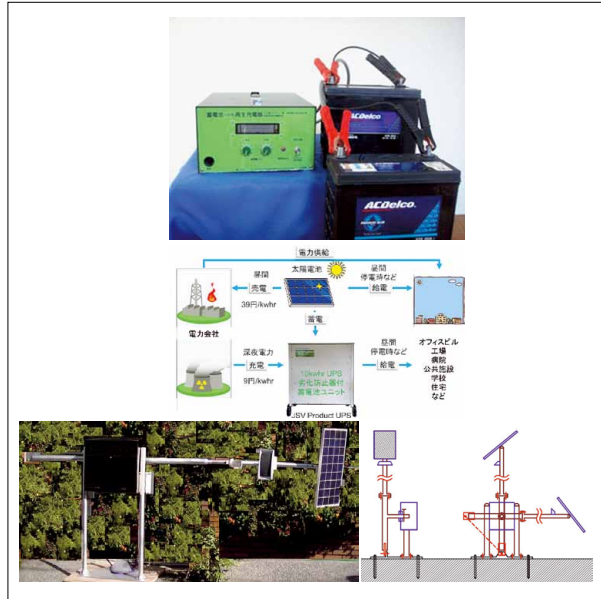
写真上:鉛蓄電池100%再生充電器 写真中央:蓄電能力劣化防止と再生装置付10kwのUPS 写真下:防災警報告知太陽光と劣化防止蓄電池で自立街路灯
