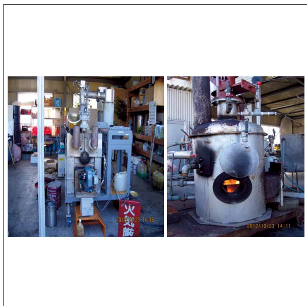
左:廃プラスチック油化装置
