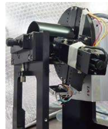
▲製作事例 光学多重反射型膜厚測定装置 (九州大学 田中敬二先生 共同開発)
