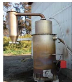
▲ドラム缶程度の大きさの燃焼炉
