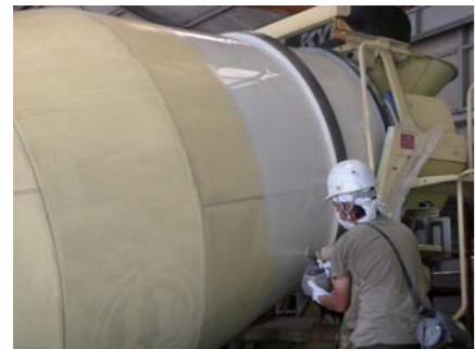
▲ 生コン車のドラムの遮熱塗装
