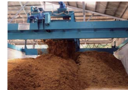
▲ 攪拌装置（稼働中）
