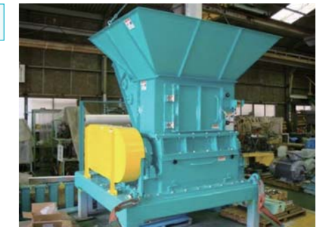
▲ A. 『万能一軸破砕機』
