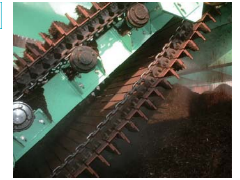
▲ スクープ式の切り返し装置で強力攪拌
