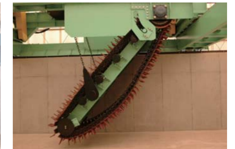
▲ 耐磨耗・耐腐蝕の専用チェーン
