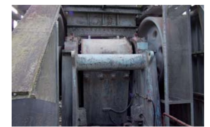
▲ 第一次破碎机 (Jaw crusherS6N)
