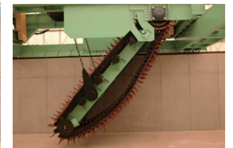
▲ 耐磨损，耐腐蚀的专用链条
