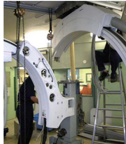
▲ 脑血管造影装置拆解搬出情况
