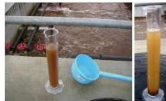
第一ばっ気槽採取 沈殿物は資材・フロック
