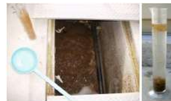
担体槽採取 浮遊物は担体
