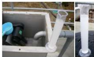
し渣スクリーン槽採取 白濁してる
