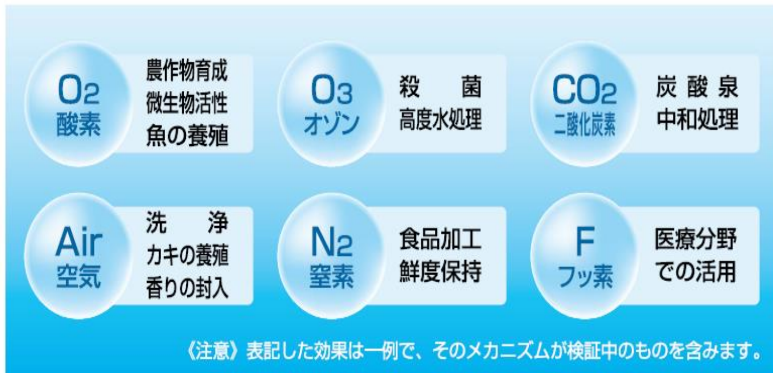
図2 ファインバブルに封入する気体とその機能
