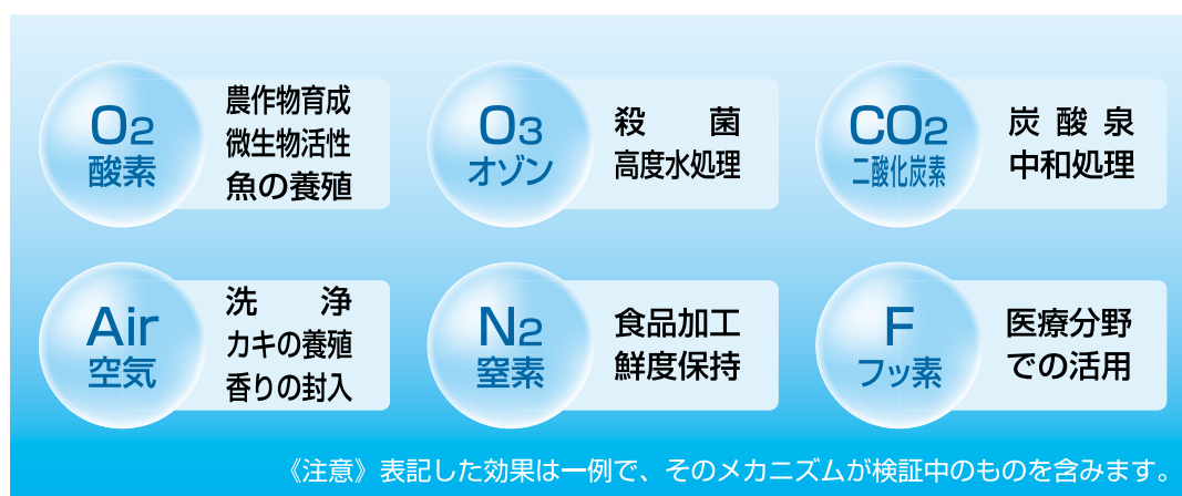
図2 ファインバブルに封入する気体とその機能
