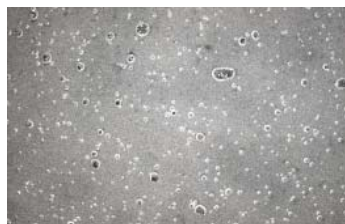
【上・中】ファインバブルを活用した『キユーピーシェフスタイルマヨネーズ』のパッケージとマヨネーズ。業務用マヨネーズのラインナップのひとつとして多くのユーザーに使われている／【下】マヨネーズを拡大した様子。マイクロサイズのバブルが多く含まれていることがわかる。
