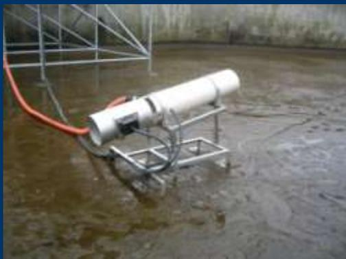
ファーム Pond(農業用水池)内で稼働する水質汚濁防止システム(流動促進浄化装置・藻類抑制併用型装置);100%自然エネルギー(太陽光・風力)で連続駆動されている。
