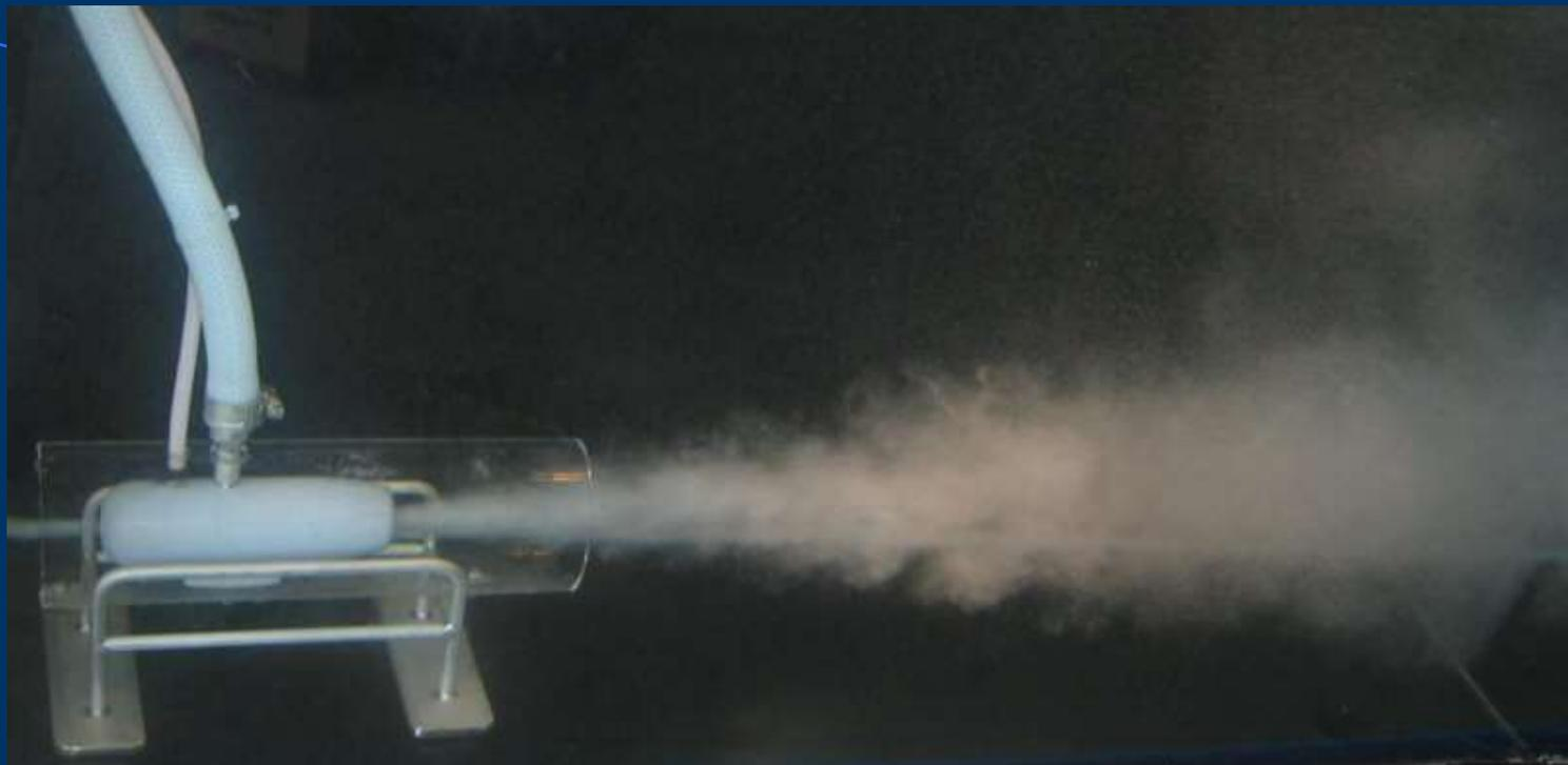
流動促進浄化装置による微細化された気泡の流れ
