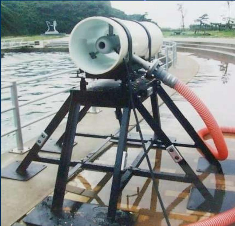
水底設置型実機の例 (円筒直径40センチ)
